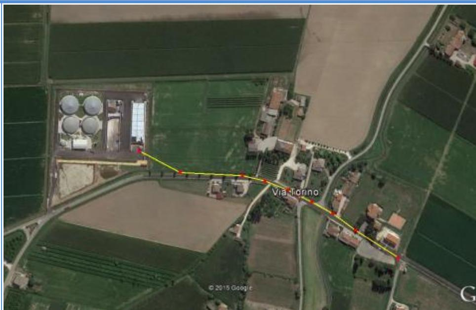
*Ripresa aerea dell'impianto di biogas tratta da Google Earth con rete di teleriscaldamento evidenziata in giallo*
